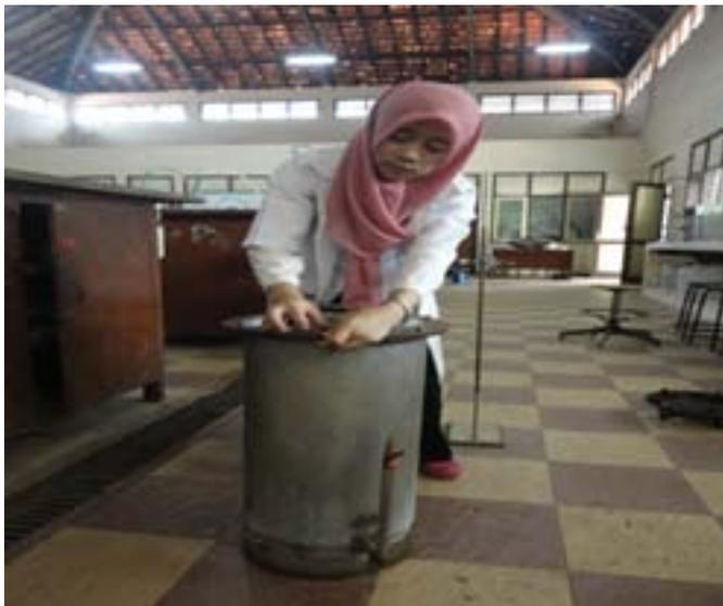
5. Kondensor diisi air hingga batas pengisian maksimal sementara boiler diisi air dan dipanaskan menggunakan kompor gas.
