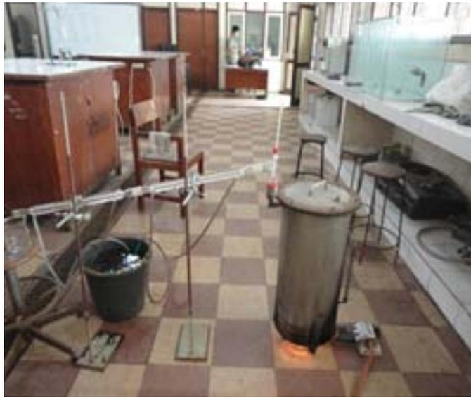
6. Steam selanjutnya dialirkan menuju ketel dengan cara membuka valve boiler secara maksimal. Penyulingan dilakukan selama waktu tertentu (2 jam dan 3 jam) terhitung sejak kondensar pertama menetes pada penampung minyak (receiver), setelah proses penyulingan selesai, minyak serai wangi pada penampung minyak (receiver) dipisahkan dari air dengan prinsip dekantasi hasil penyulingan diukur dan disimpan pada botol pada suhu kamar.
