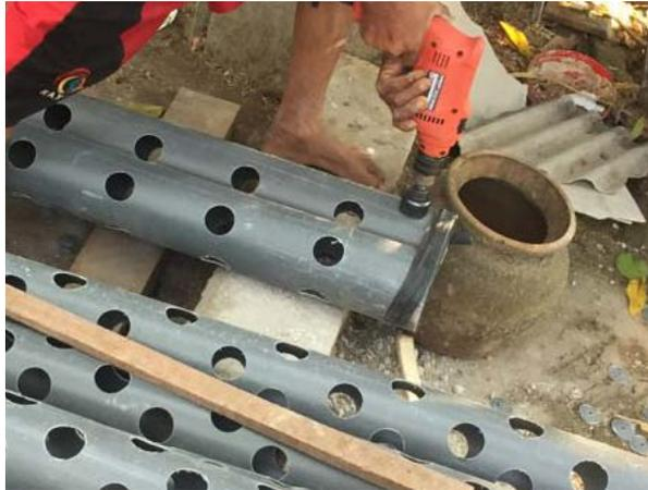
*Gambar proses pembuatan lubang tanam pada pipa PVC*
